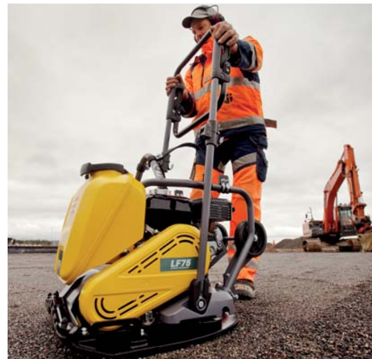
Благодаря креплению в центре машины ручку можно поднять в вертикальное положение, что облегчает работу возле препятствий.
