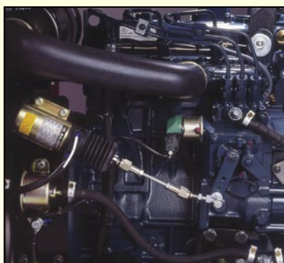
P14 – Автомат перевода на холостые обороты при отсутствии нагрузки
