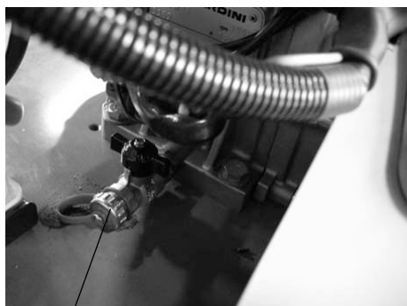
Рис. Двигатель 1. Измерительный стержень для масла/заполнение 2. Сливная пробка
