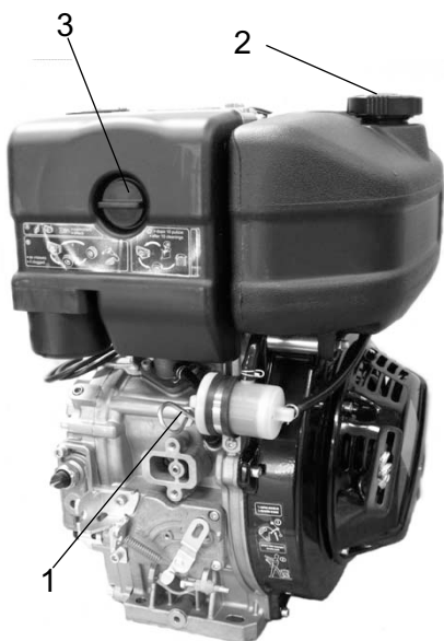
Рис. Двигатель 1. Измерительный стержень для масла 2. Крышка топливного бака 3. Воздушный фильтр
