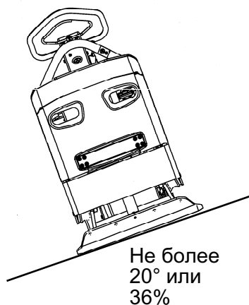
Рис. Работа на откосах
