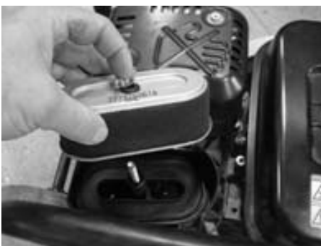
Рис. Замена воздушного фильтра.
