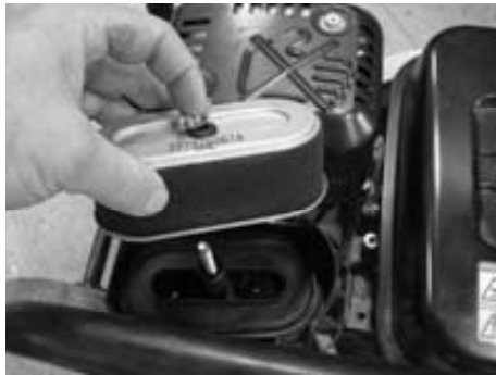
Рис. Замена воздушного фильтра.
