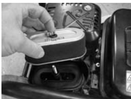
Рис. Замена воздушного фильтра.
