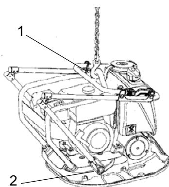
Рис. Машина, готовая к подъему
