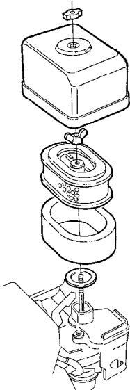
Fig. Byte av luftfilter.
