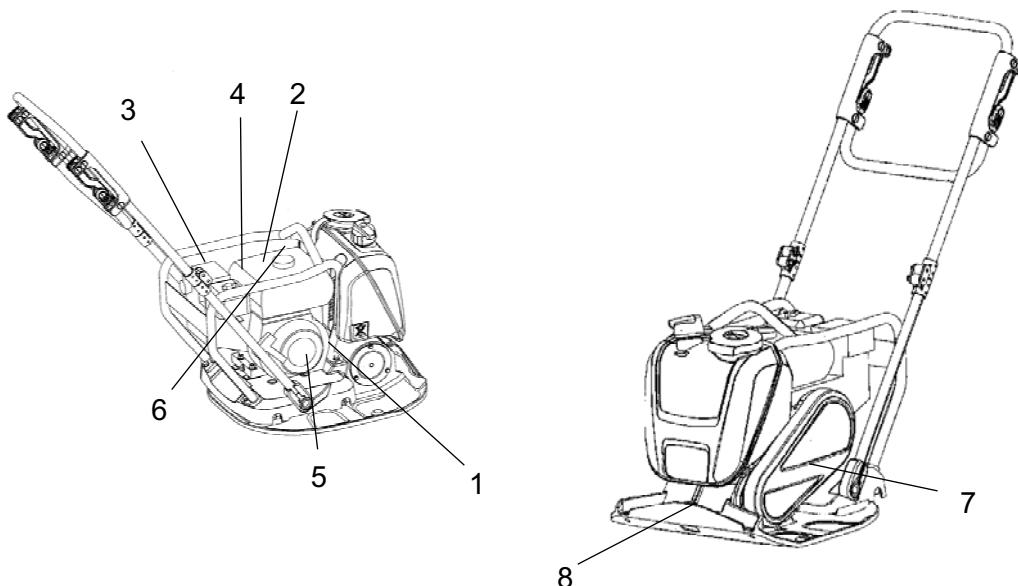
Рис. Позиции проведения технического обслуживания
